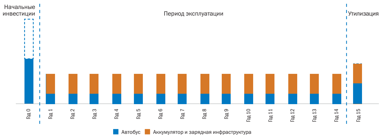
Рис. 19. Обзор жизненного цикла: аккумулятор как услуга
